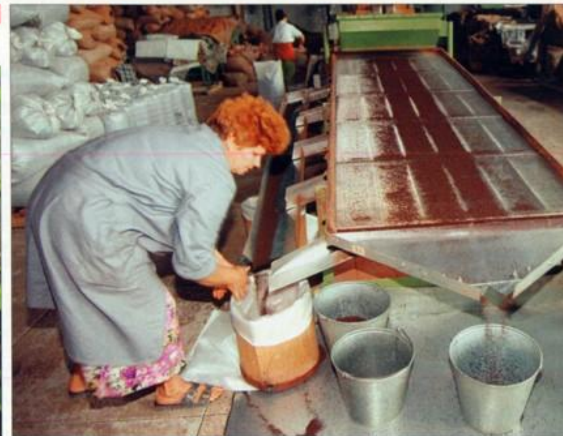
НА ВОЛКОВСКОЙ ЧАЙНОЙ ФАБРИКЕ ПРОИЗВОДИТСЯ ГРАНУЛИРОВАННЫЙ ЧАЙ. СПЕЦИАЛЬНАЯ МАШИНА РАЗМЕЛЫВАЕТ ЧАЙНЫЙ ЛИСТ (ВВЕРХУ СЛЕВА), ЧЕРЕЗ ШЕСТЬ ЧАСОВ С КОНВЕЙЕРА ВЫХОДЯТ ГОТОВЫЕ ГРАНУЛЫ
