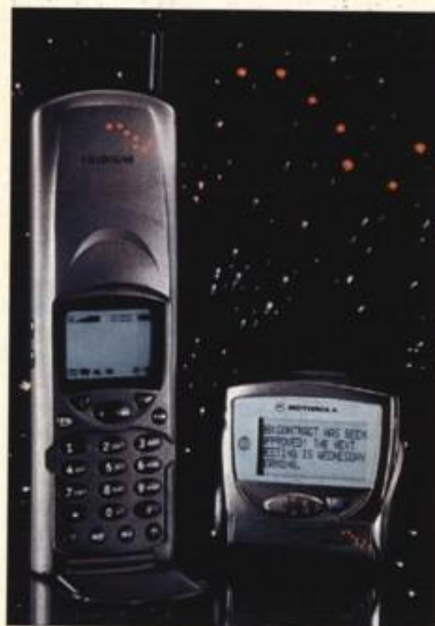
СПУТНИКОВЫЙ ТЕЛЕФОН И СПУТНИКОВЫЙ ПЕЙДЖЕР ПРОИЗВОДСТВА КОМПАНИИ MOTOROLA (ДЛЯ СПУТНИКОВОГО ПРОЕКТА Iridium). НА ВИД ТЕЛЕФОН МАЛО ЧЕМ ОТЛИЧАЕТСЯ ОТ ОБЫЧНОГО СОТОВОГО, А ПЕЙДЖЕР — ОТ ПРИВЫЧНОГО ВСЕМ РАДИОПЕЙДЖЕРА. НО ЭТИ АППАРАТЫ СПОСОБНЫ ОБЕСПЕЧИТЬ УСТОЙЧИВУЮ СВЯЗЬ АБСОЛЮТНО В ЛЮБОЙ ТОЧКЕ ЗЕМНОГО ШАРА, ДАЖЕ ТАМ, ГДЕ МЕСТНЫЕ ЖИТЕЛИ (ЕСЛИ ОНИ ЕСТЬ) НИКОГДА НЕ СЛЫШАЛИ НИ СЛОВО «СОТА», НИ «ТЕЛЕФОН». ВСЕГО ПАРУ ЛЕТ НАЗАД СПУТНИКОВЫЙ ТЕЛЕФОН БОЛЬШЕ НАПОМИНАЛ ПО РАЗМЕРАМ ЧЕМОДАН
