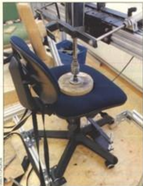
ВСЕ НОВЫЕ МОДЕЛИ ПЕРЕД ЗАПУСКОМ В ПРОИЗВОДСТВО Тестируются на прочность в центральной лаборатории в Эльмхульте
