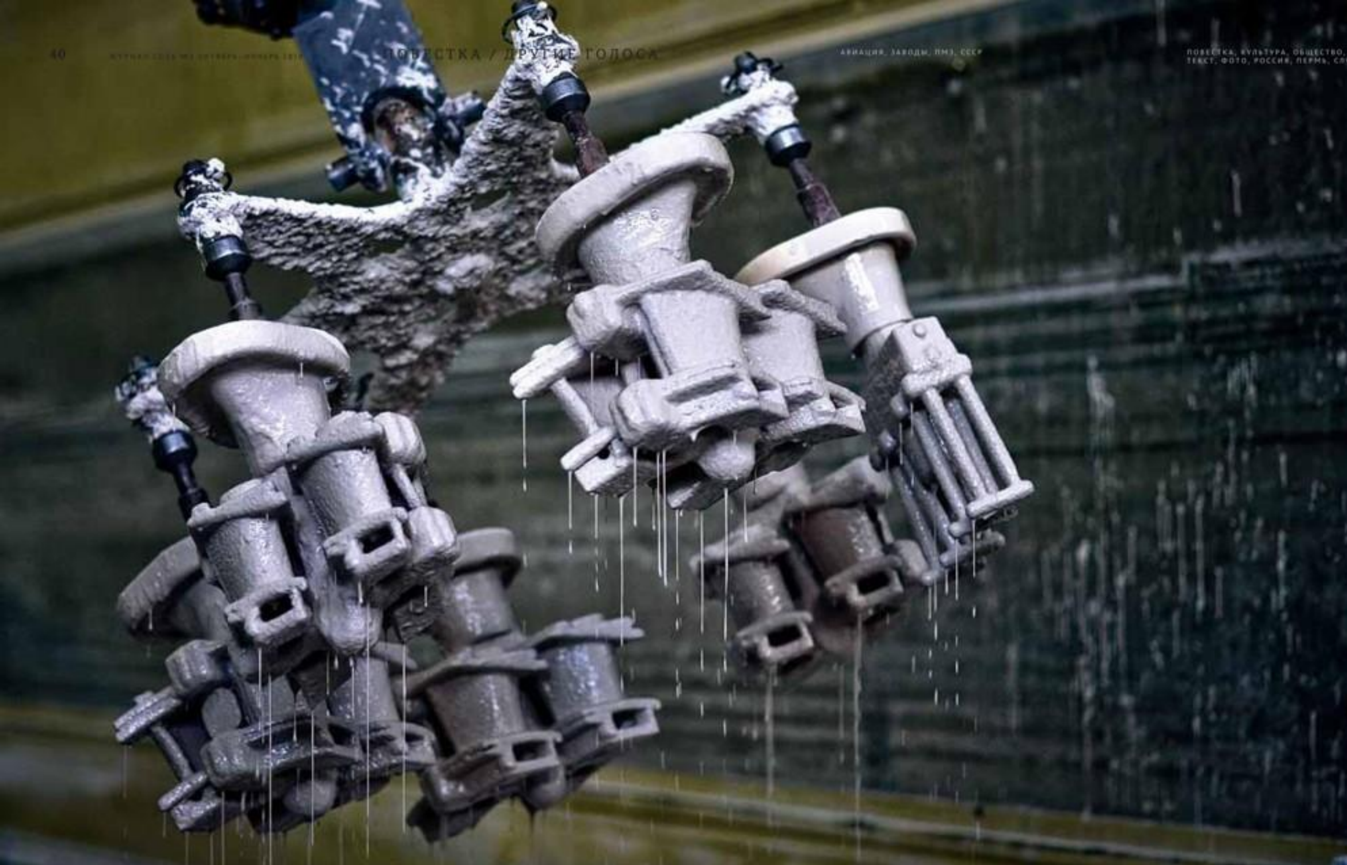
Рабочие из цеха № 13 очень гордятся роботом, который помогает им изготавливать формы для отливки деталей. Рука робота погружается в керамическое тесто, потом выныривает и долго ждет, пока стечет излишек.
