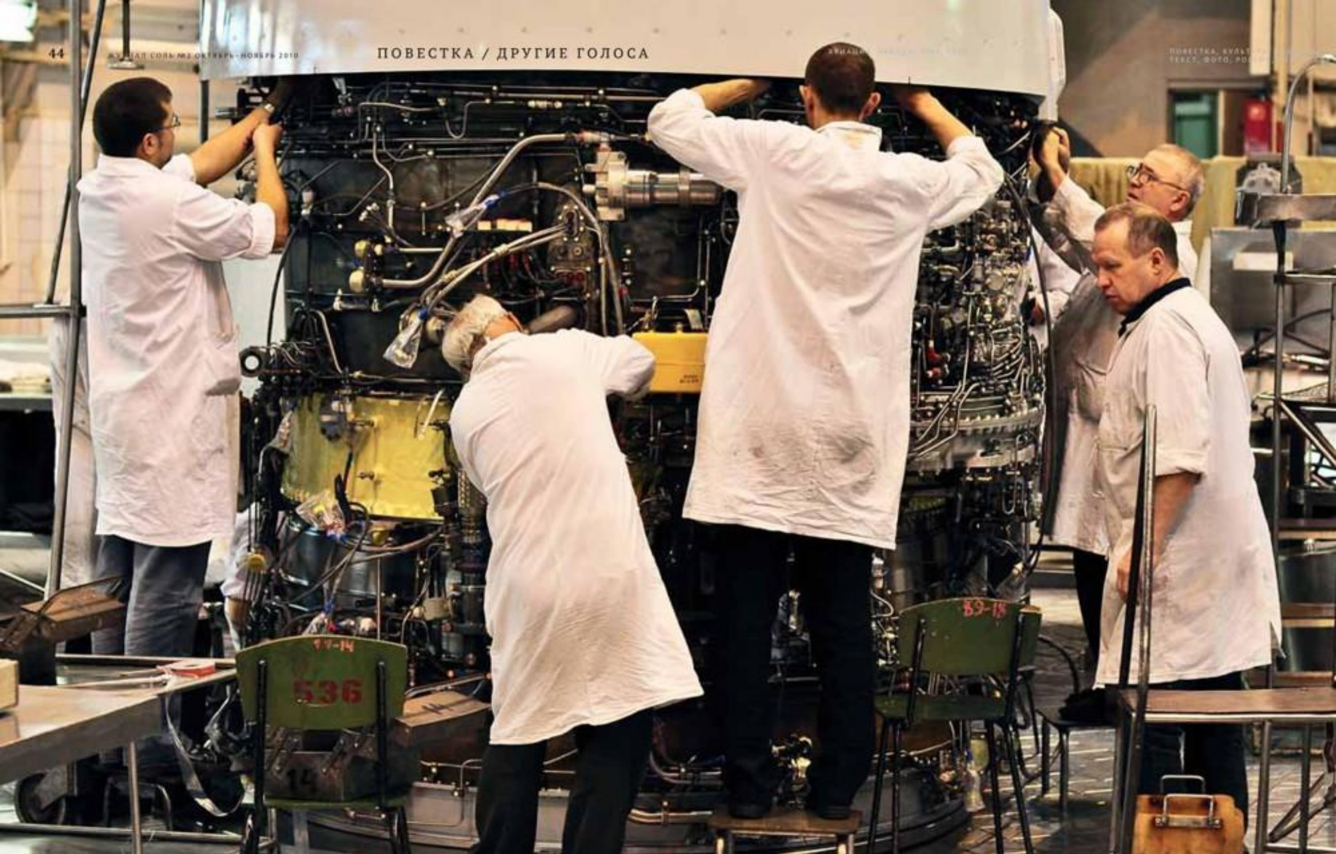
Цех сборки — самый цивилизованный. Здесь люди в белых халатах, а не в синих и тем более не в спецуках. В центре зала огромный двигатель из 15 тысяч деталей, вокруг него суетятся сборщики. Это не простой двигатель, а президентский. Для самолета, на котором улетит Медведев. Двойная ответственность
